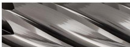
При использовании борфрез PFERD с покрытием NICOAT HC-NFE стружка при обработке мягких алюминиевых сплавов не прилипает. За счет этого увеличивается срок службы инструмента, и улучшается качество поверхности заготовки.
