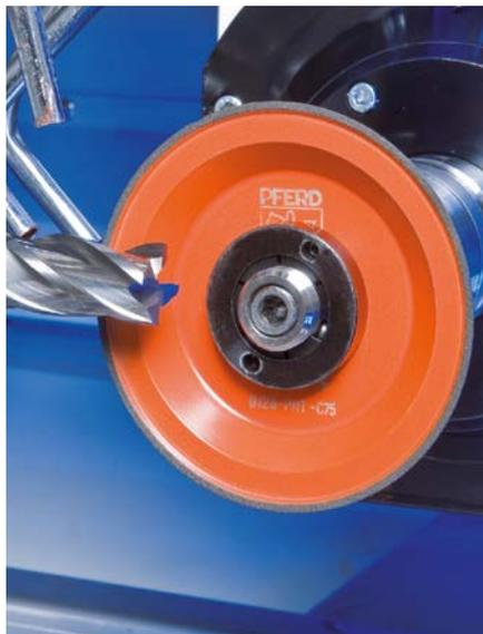
Шлифовальные круги с алмазом и CBN на связке на основе искусственных смол часто используются для шлифования инструментов из твердых металлов или быстрорежущей стали (HSS), а также в других процессах шлифования. Они используются и для мокрого, и для сухого шлифования.
