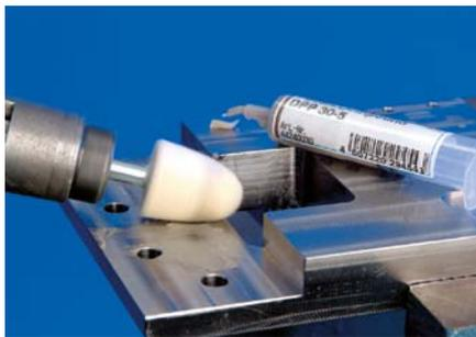
Алмазные полировальные пасты используются для обработки очень твердых материалов, например, твердого металла и закаленной стали. Их применяют в сочетании с войлочными полировальными головками и кругами. Алмазные полировальные пасты могут быть водо- и спирторастворимыми.
